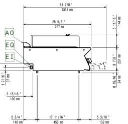
Electrical inlet (power) EQ **Equipotential screw**
